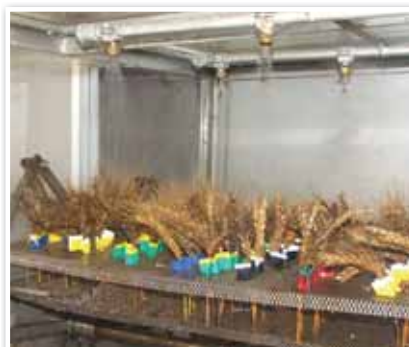
Figuur 3. Reënabootser waarin are vir uitloopweerstand getoets word.
