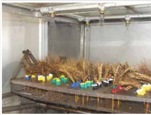
Figuur 3. Reënabootser waarin are vir uitloopweerstand getoets word.
